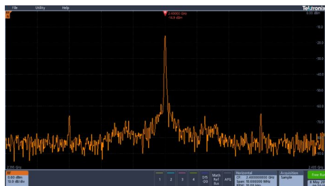
Отображение спектра комбинированным осциллографом серии 3
